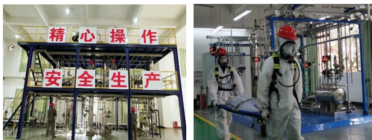
图6 利用在仿真工厂及HSE化工安全仿真平台进行应急演练
