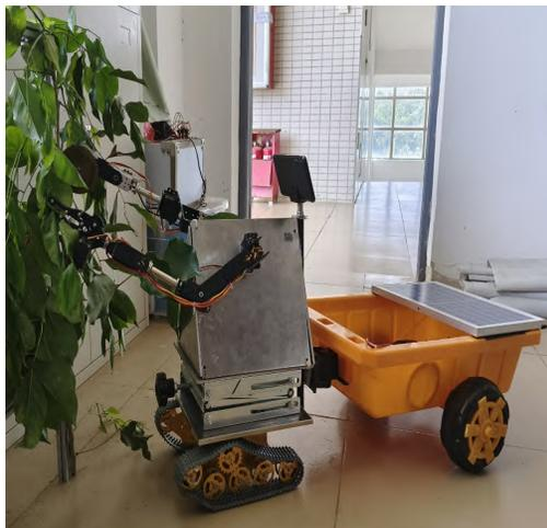
图5 智能园艺剪枝机器人样机测试
