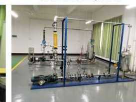
管路拆装实训装置
