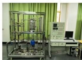
化工过程控制实训装置
