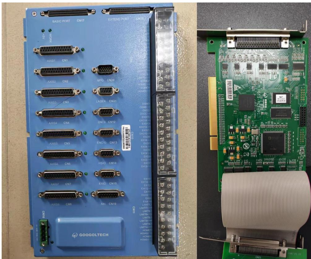
图 1-2 GTS-800-PV-PCIe 控制卡（右边）和端子板（左边）
