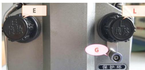
功能：测量电气线路和电气设备的绝缘电阻，数值越大越好。测量低压线路和设备选用 500 伏或 1000 伏的兆欧表，测量高压设备和线路选用 1000 伏或 2500 伏。手摇发电机输出的电源是直流电压值，黑线接的是发电机电源的正极，红笔接的是发电机电源的负极。
